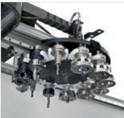
Depósito revólver com 12 lugares no cabeçote e de 16 lugares no carro X.
